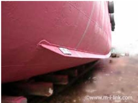
Gambar 2 : *Bilge keel* pada lambung kapal
