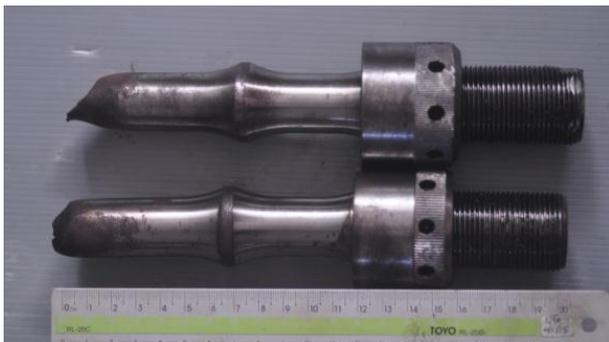
**Gambar 5 :** Patahan dg reduksi penampang yg besar (atas)
