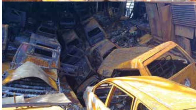
Gb. 5 Kerusakan konstruksi upper car deck yang mengalami deformasi akibat paparan panas dari bagian bawah
