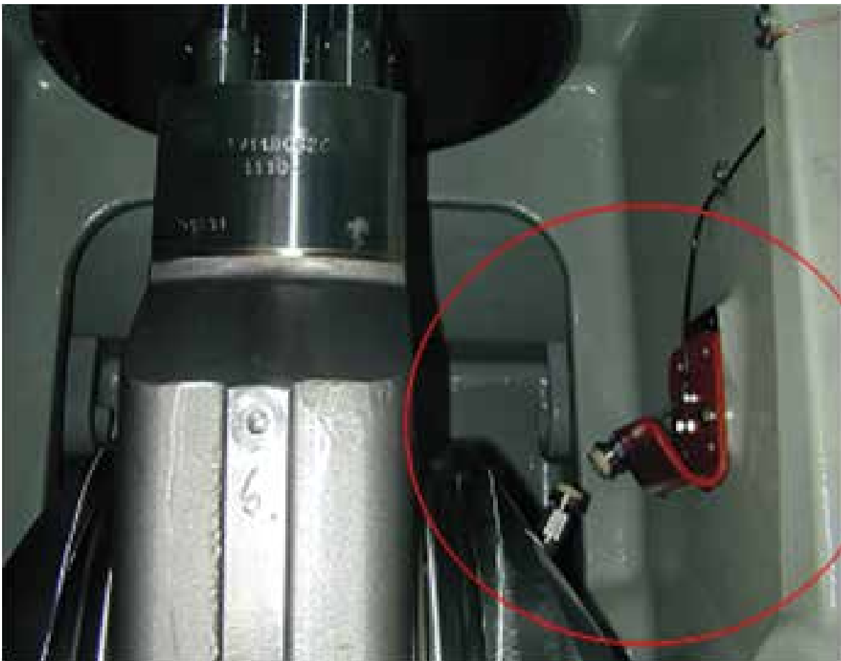
Gambar 4: Pemasangan sensor untuk memonitor crankpin
